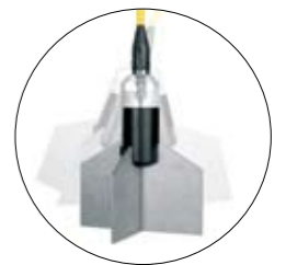
Ved strømpåvirkning vil Strømsensoren endre vinkel som en pendel. Vinkelen måles elektronisk og konverteres til cm/sek.
