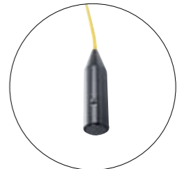
Den eksakte konsentrasjonen av oksygen måles ved at Oksygensensoren belyser en folie med modulert blått lys og måler faseskiftet på det reflekterte røde lyset. Signalet blir da linearisert og temperaturkompensert.
