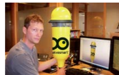
Doppler Pelletsensor med trådløst nettverk (CAP) i kombinasjon med CCS fôringsanlegg, gir en perfekt kontroll av fôringen.
