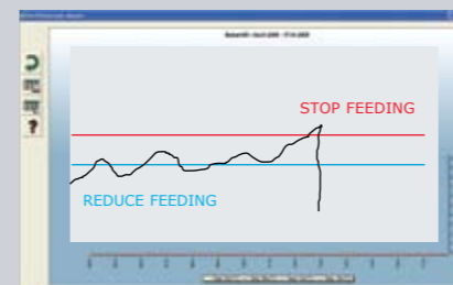
Pelletsensoren regulerer fôringen basert på mengden av uspist pellet som passerer sensorområdet.
