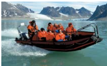
Los Cascos RIB de Polarcirkel son auto ajustables y tiene pontones rígidos rellenos con poliestireno que los hace inhundibles!
