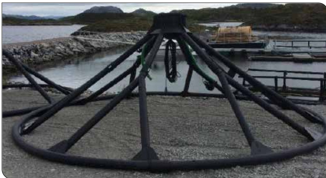
Illustrasjon 3: Korrekt lagret AKVA Subsea Feeder bunn
