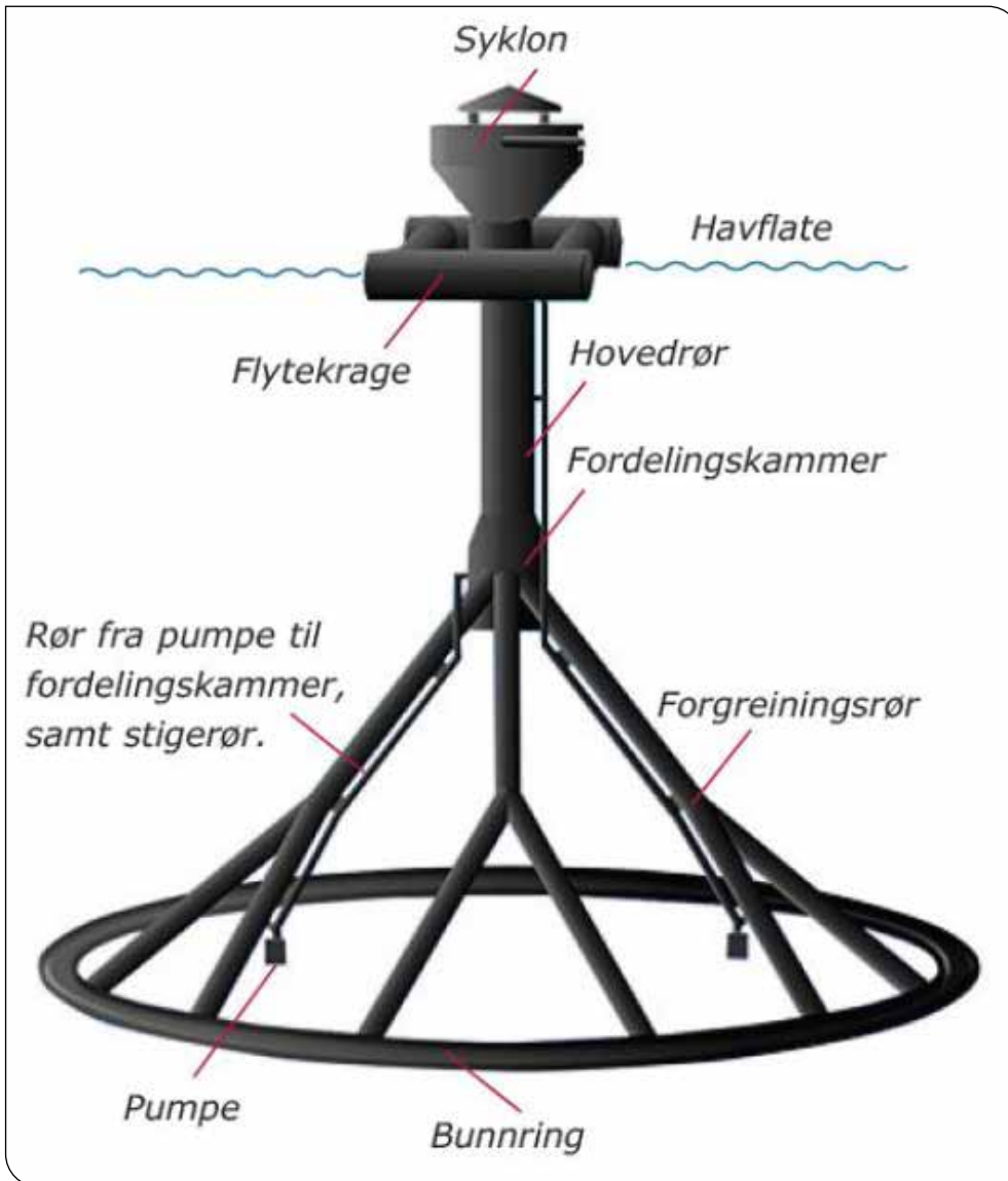
Illustrasjon 1: AKVA Subsea Feeder komponenter
