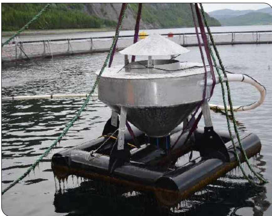
Illustrasjon 5: Løfteoperasjon AKVA Subsea Feeder
