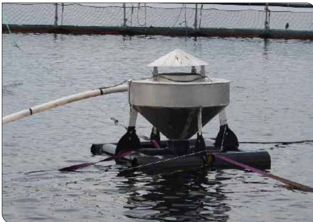
Illustrasjon 7: AKVA Subsea Feeder plasseres midt i merden
