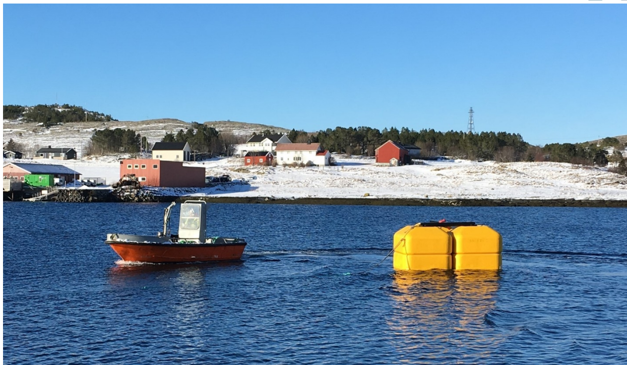
Figur 6 Bøyepunkt med 3 sammensveide bøyer på til sammen 12 tonn
