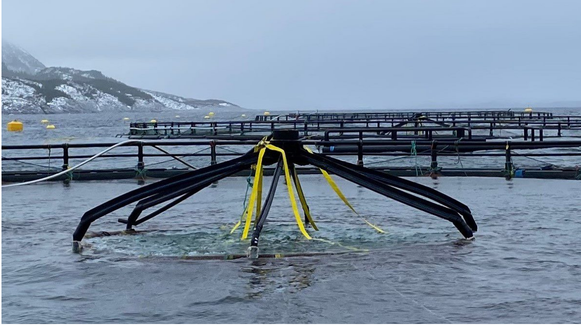
Luftkuppel i hevet posisjon
