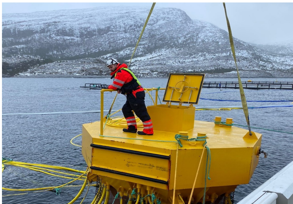
Testing av ventilbøye
