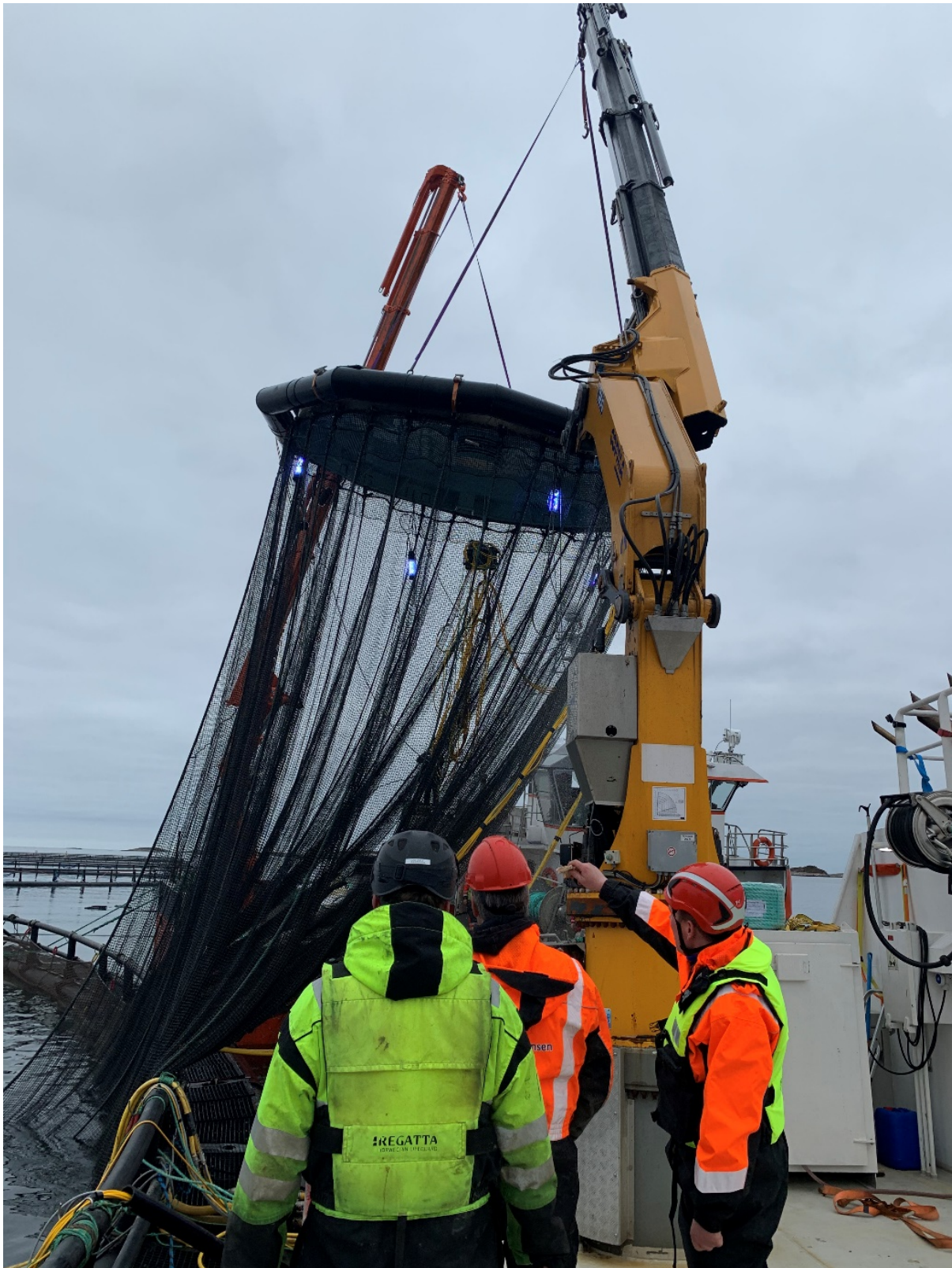
Fjerning av tak med luftkuppel
