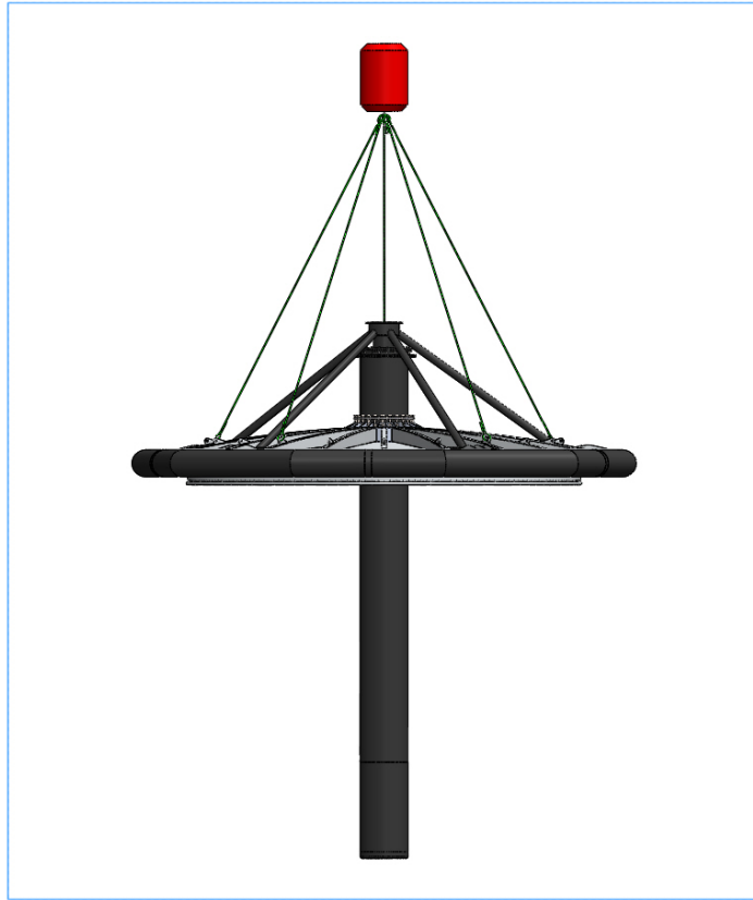
Figur 1 Ombygd kuppel med loddrør og bøye
